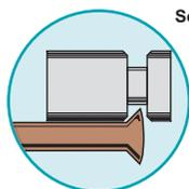
Scanalature per il taglio di tubi con estremità flangiate a 45°
